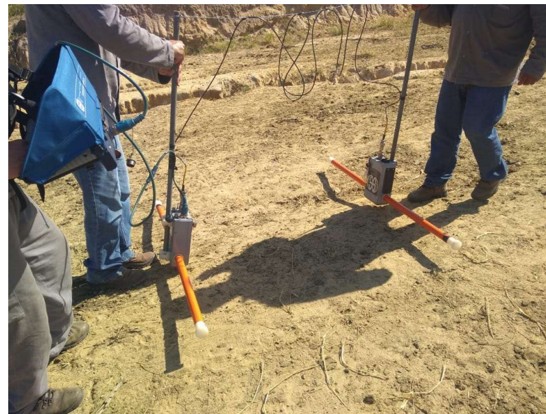
Levantamento GPR. Fonte: Autores, 2018
