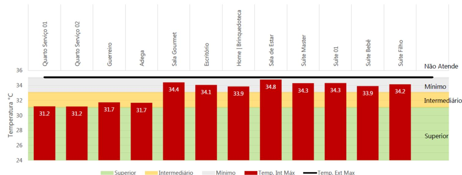
Nesta simulação, o impacto na troca de vidros ocorreu em todos os ambientes do térreo e do pavimento superior, reduzindo a temperatura em até 0.5°C.
